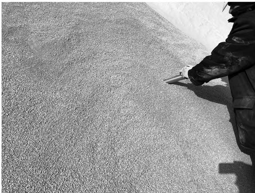
Рисунок 9 — Отбор точечных проб песка пробоотборной трубкой
