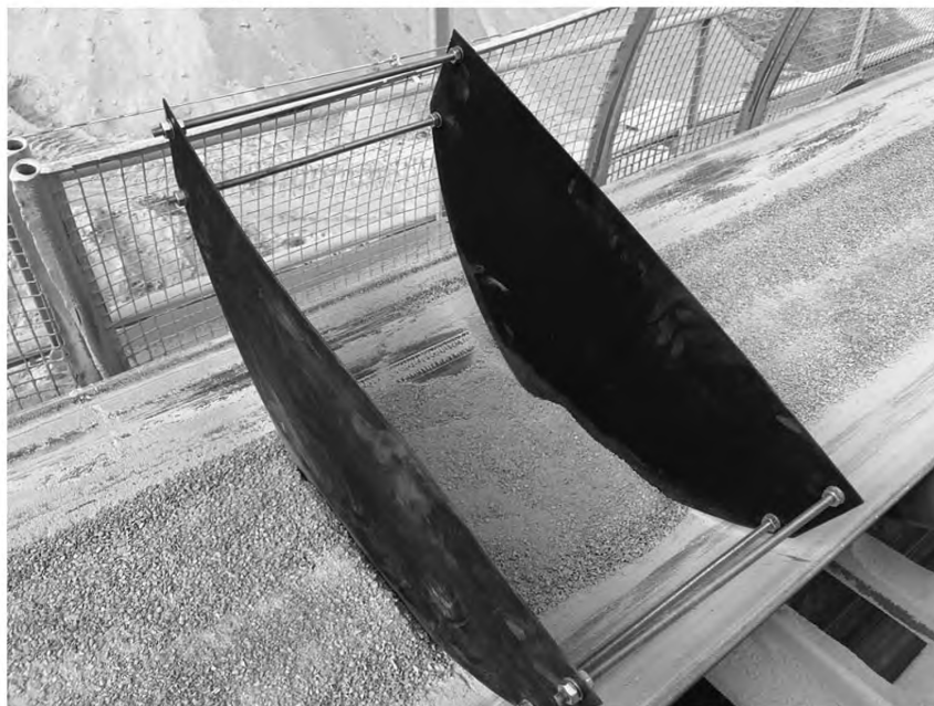
Рисунок 5 — Отбор проб песка с конвейерной ленты с применением пробоотборной рамы
